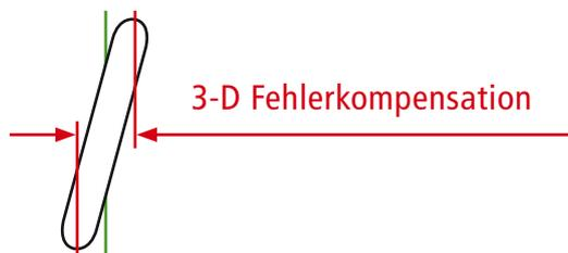
*Problem:* Doppelseitig tastende 2-Achs-Konturmessgeräte verletzen prinzipiell das Tastschnittprinzip durch unvermeidbare 3-D-Fluchtungsfehler von oberer zu unterer Tastspitze. Konturmessgeräte mit manuell zu betätigender Quer-Verstellung können hier keine Fehlerkompensation bieten.
