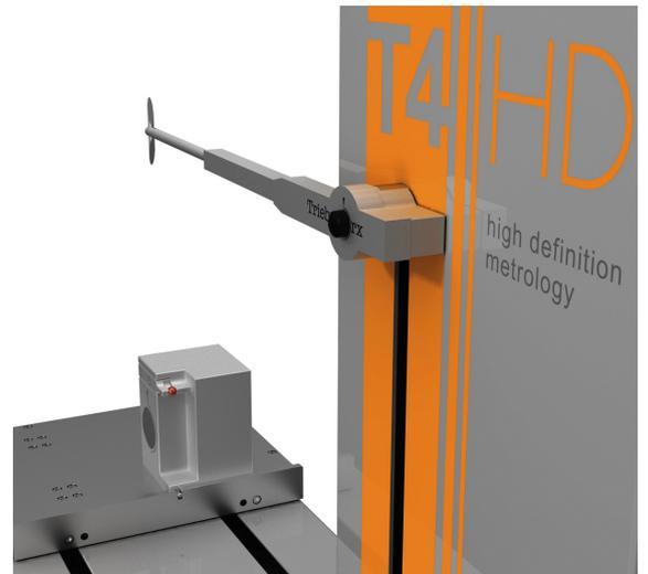
*Problem:* Kontur- und Rauheitsmessgeräte mit massiver Z-Säule können beim Teach-In der Messprogramme den freien Blick auf Bohrungen und Prüflinge verhindern. Längere Prüflinge, wie Wellen oder Kugelgewindespindeln müssen oft für die Messung abgelängt werden, um die Kollision mit dem Messgerät zu vermeiden.
